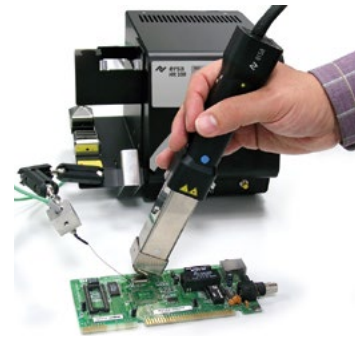
Schnell, einfach und sicher manuell Entlöten
