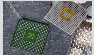
3. Reballing - Aufbringen neuer Lötbälle
