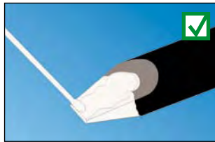
Benetzung einer Lötspitze
