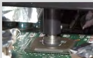
5. Platzieren des neuen Bauteils
