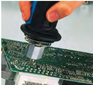
Entlöten massereicher bedrahteter Bauteile mit dem X-TOOL
