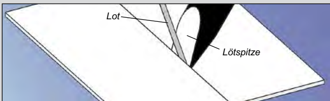
Kolbenführung beim Löten einer schmalen Naht
